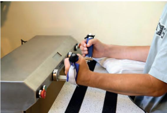
**Abb. 17:** Beispiel eines Arm-Trainingroboters: der Bi-Manu-Track
