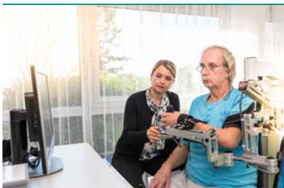
Abb. 2: Mehrgelenkiges Exoskelettsystem zur Bewegungsführung und Training der oberen Extremität in der Ergotherapie
